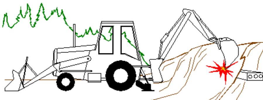
Figura 1 - Contatto con linee elettriche interrate
